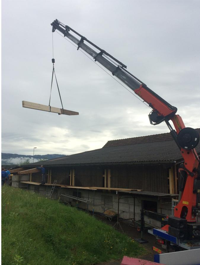
Der Palfinger-Kran, Modell PK 29002 G, ist sehr vielseitig und kann neben einer Seilwinde mit diversen anderen Arbeitsgeräten ausgestattet werden.
