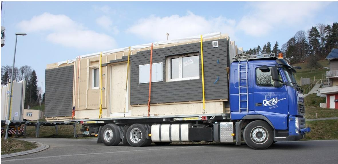
3-Achs-Volvo mit Wechselbrücke für variables Transportgut (Bild: Wandelemente für MFH).
