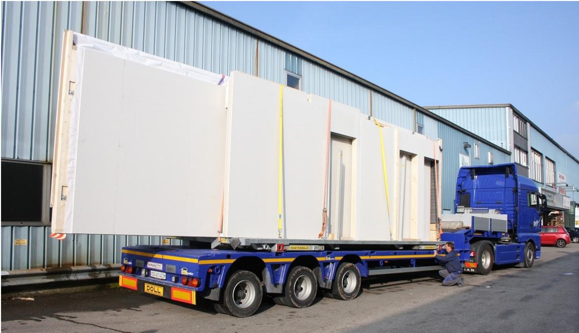
Sattelschlepper, beladen mit Wechselpritsche und Wandelementen.
