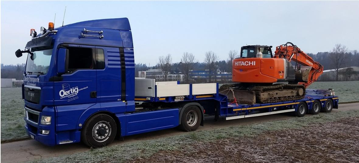
Sattelschlepper mit leichter Auffahrrampe, Nutzlast bis 20'000kg.
