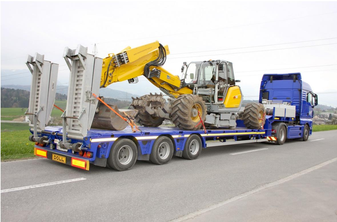
Flexible Lösung mit demontierbarer Auffahrrampe.
