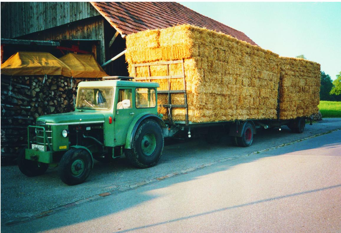
Traktor und zwei Einachsanhänger mit Luftdruck-Bremse, Nutzlast je 7t.
